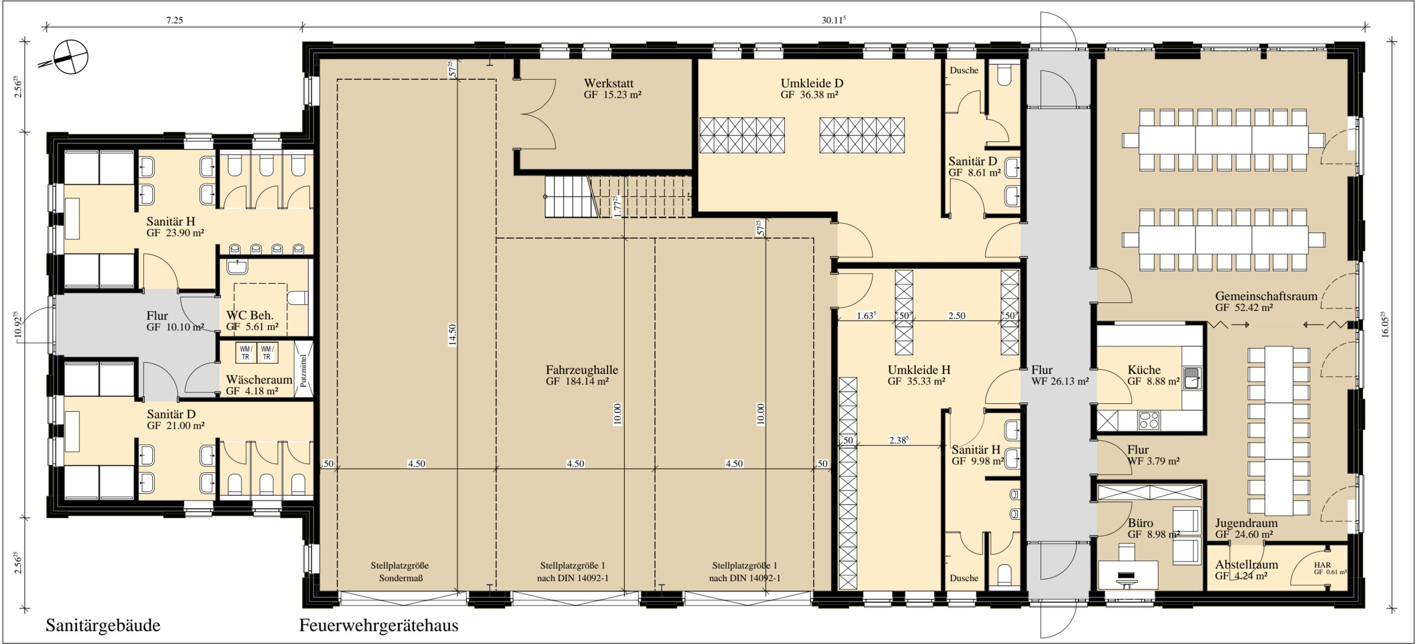
Grundriss Erdgeschoss Variante 2 | M 1:100
