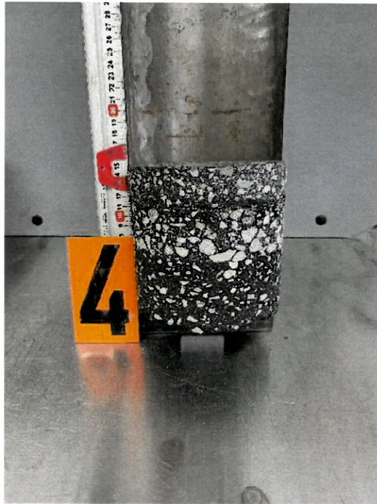
Abb. 7: Asphaltbohrkern 04 (s. Lageplan RKS 04)
