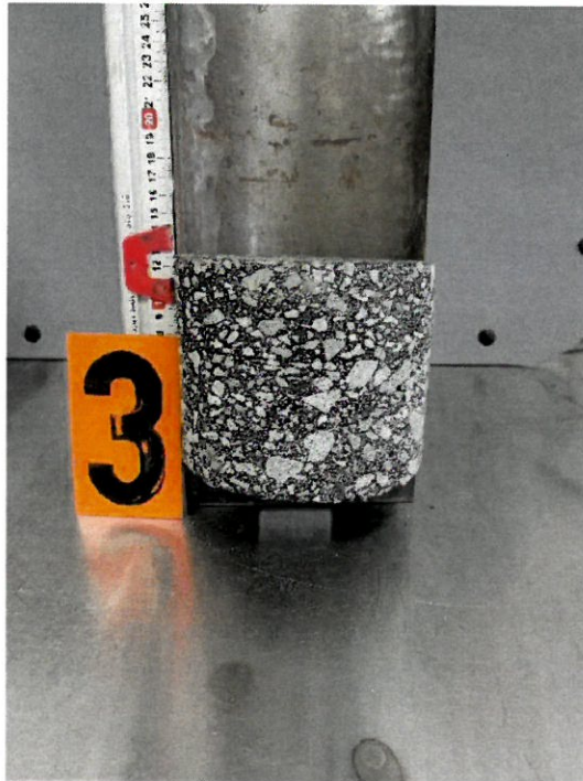
Abb. 6: Asphaltbohrkern 03 (s. Lageplan RKS 03)
