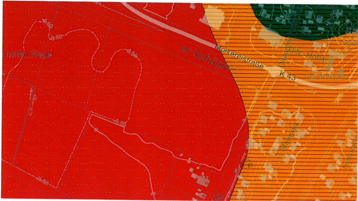
Abbildung 3: NIBIS Kartenserver (2022); Sulfatversäuernde Böden im niedersächsischen Küstenraum Tiefenbereich 0–2m- Landesamt für Bergbau, Energie und Geologie (LBEG) Hannover. Grün: schwefelarmes, verbreitet kalkhaltiges Material. Gelb: Kalkfreies, toniges Material, örtlich mit sulfatsaurem Material. Rot: kalkfreies, aktuell oder potentiell sulfatsaures Material.
