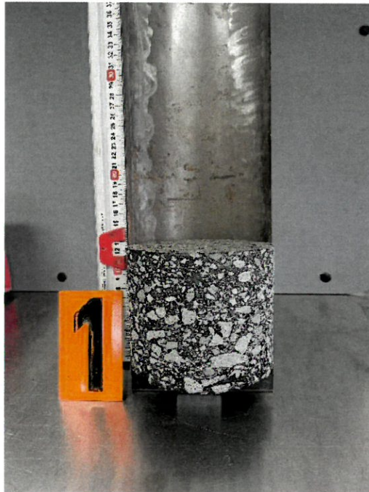
Abb. 4: Asphaltbohrkern 01 (s. Lageplan RKS 01)
