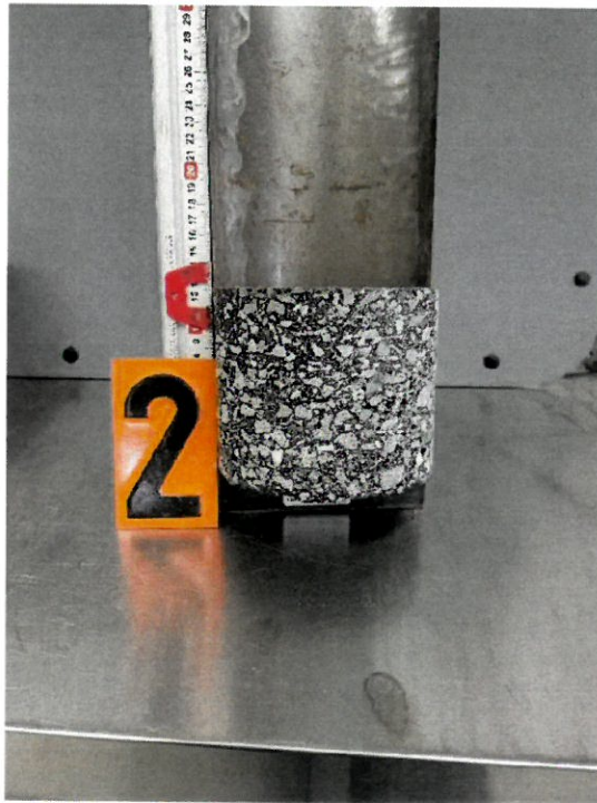
Abb. 5: Asphaltbohrkern 02 (s. Lageplan RKS 02)
